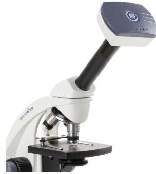
MicroBlue monocular con cámara que reemplaza el ocular original
