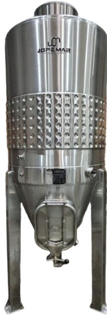
Tanque fermentador de acero inoxidable 304 pulido para fermentación de vino con cinta refrigerante sobre patas, con una capacidad de 1000 litros, fondo cónico desplazado y techo cónico de 15°.
